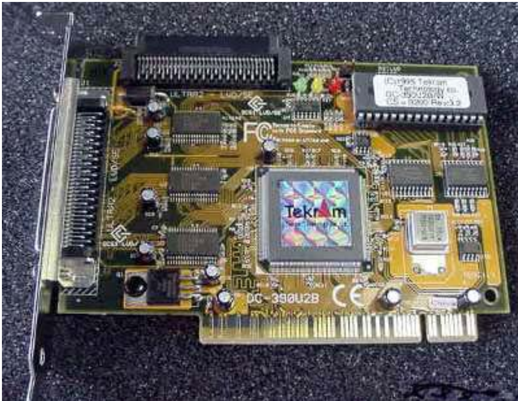
Noen få hovedkort har innebygget SCSI kontroller, men de fleste må benytte et SCSI kontrollerkort. Her ser vi det samme PCI baserte kortet, et SCSI kontrollerkort med en ekstern og en intern kontakt. (Samme kort som over.)
