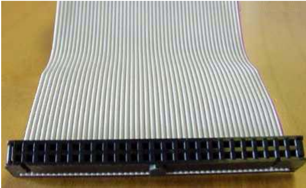
Interne SCSI enheter kobles til ved bruk av en 50 pins parallellkabel (flatkabel).
