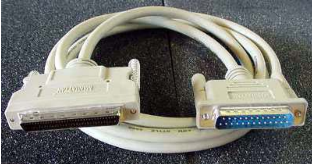
Eksterne SCSI enheter kobles til kontrollerkortet via en tykk rund kabel.
