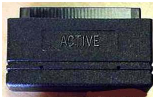
En aktiv terminator, legg merke til hva som står skrevet på selve enheten.
