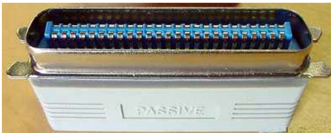
Noen SCSI terminatorer er bygget rett inn i SCSI enheten (devisen), mens andre enheter krever en ekstern terminator, en slik som vi ser avbildet her. Legg merke til hva som står skrevet på selve enheten.
