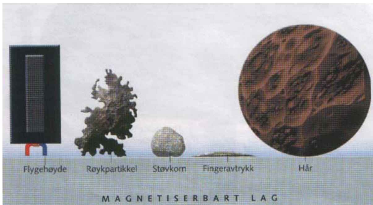
Illustrasjon av størrelsesforhold / avstander i en harddisk
